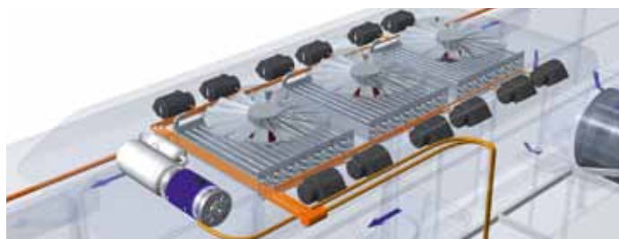
DCU/PSU: Steuerung Kompressor und Belüftungssystem
