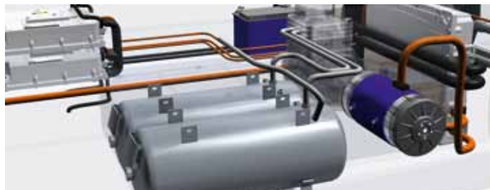
DCU: Steuerung elektrischer Kompressor
